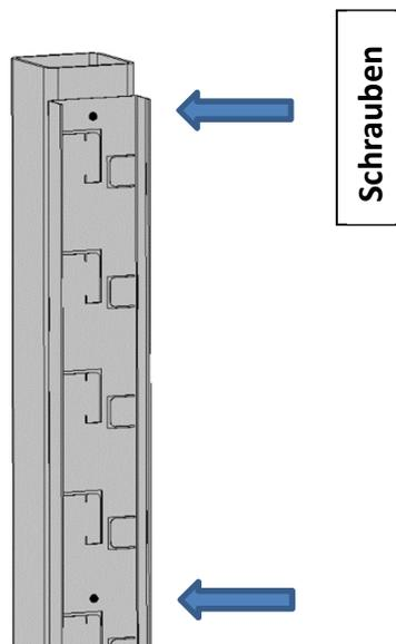
Die C-Schienen werden in der Wasserwaage an die Pfosten montiert.
