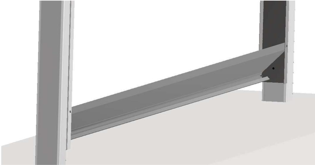
Die restlichen Lamellen werden ebenso von unten nach oben wie im Punkt 4 montiert. (Der Abstand von Lamelle zu Lamelle beträgt standardmäßig 75mm)
