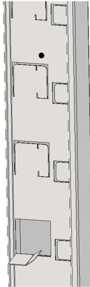
Die Lamelle wird auf den unteren Pin von der C-Schiene aufgelegt und mit dem oberem Pin fixiert.
